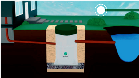
Схема монтажа Малахит AIR 2
